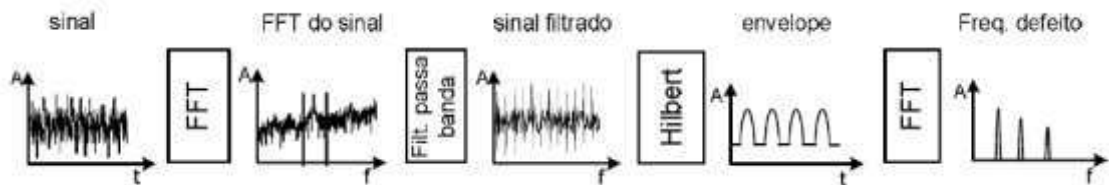
Figura 5 - Procedimento adotado na demodulação de sinal
