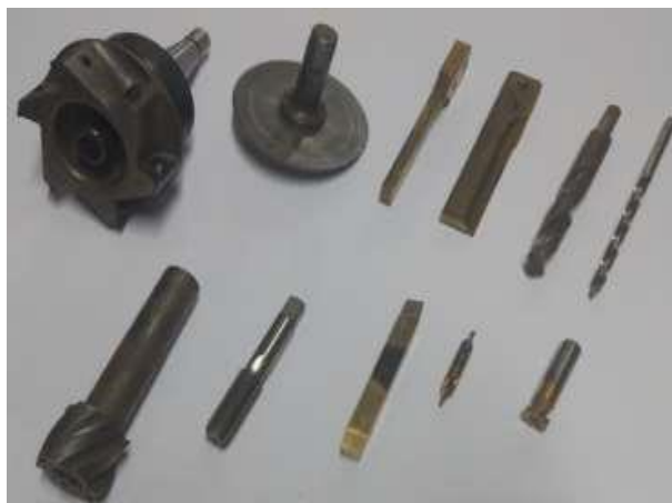
FIGURA 1 – Exemplos de ferramentas feitas de aço rápido
