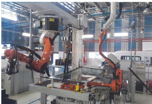
Figura 4 – Célula robótica de colagem do para-brisa.
