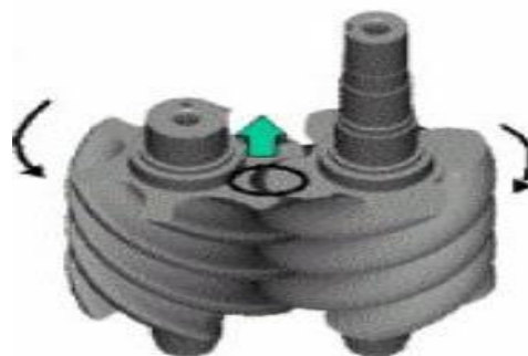
Figura 3 - Processo de Sucção
